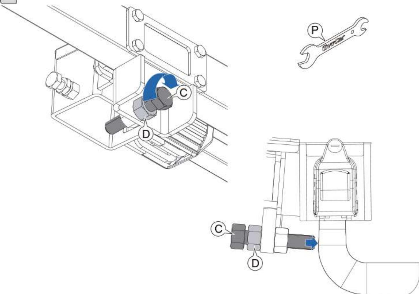
**ES** Ajuste del sistema antibalanceo: Afloje la contratuerca (D) y gire el tornillo (C) hasta que haga contacto con el cuello de la bola del enganche. Vuelva a apretar la contratuerca (D). Esta operación se realizará solo la primera vez que coloquemos nuestro portamotos en el vehículo o si lo colocamos sobre un vehículo diferente al nuestro.
