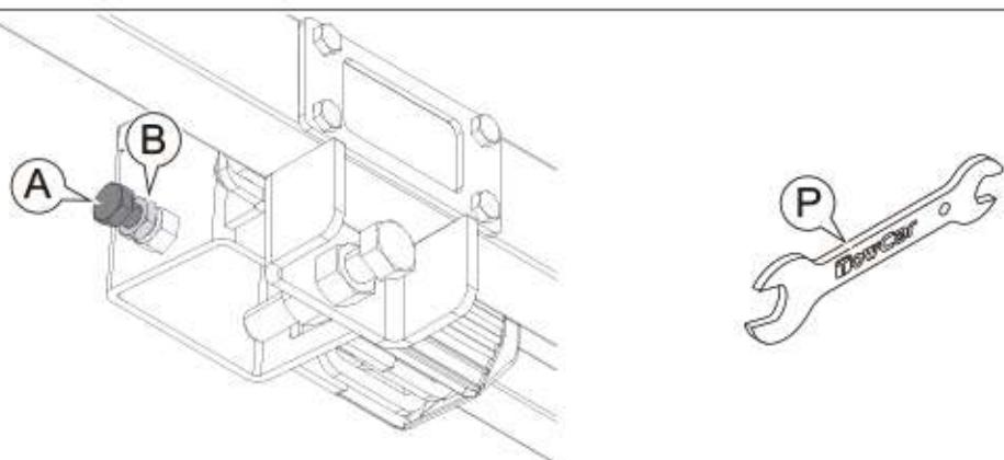
**ES** Ajuste del cabezal: Afloje la contratuerca (B), apriete el tornillo (A) hasta que el cabezal no pueda girar (en caso de que no sea posible bajar la palanca con la fuerza de la mano, afloje un poco el tornillo). Una vez se consiga un buen ajuste, apriete la contratuerca (B). Esta operación debe ser repetida cada cierto tiempo.
